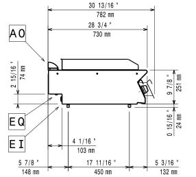
Electrical inlet (power) Equipotential screw
